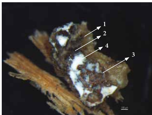
18. Rudos spalvos dažų mėginys. Nuotraukoje (X40) matyti baltas kreidinis klijinis gruntas (1), labai plonas „voratinklinis“ juodas sluoksnis (2), rudas dažų sluoksnis (3), baltos spalvos restauracinis gruntas su cinko baltuoju pigmentu (4). Būtent šio restauracinio grunto sudėtis buvo analizuota rentgenodifrakciniu metodu (XRD)
