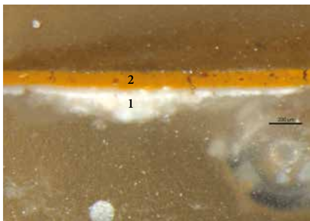
20. Mėginys nuo fono. Skerspjūvio nuotraukoje (X40) matyti baltas kreidinis klijinis gruntas (1) ir geltonos spalvos temperinių dažų sluoksnis su geltonosios ochros pigmentu (2) Sample from yellow background. The photo (X40) shows white (1) and yellow tempera paint layer (2)
