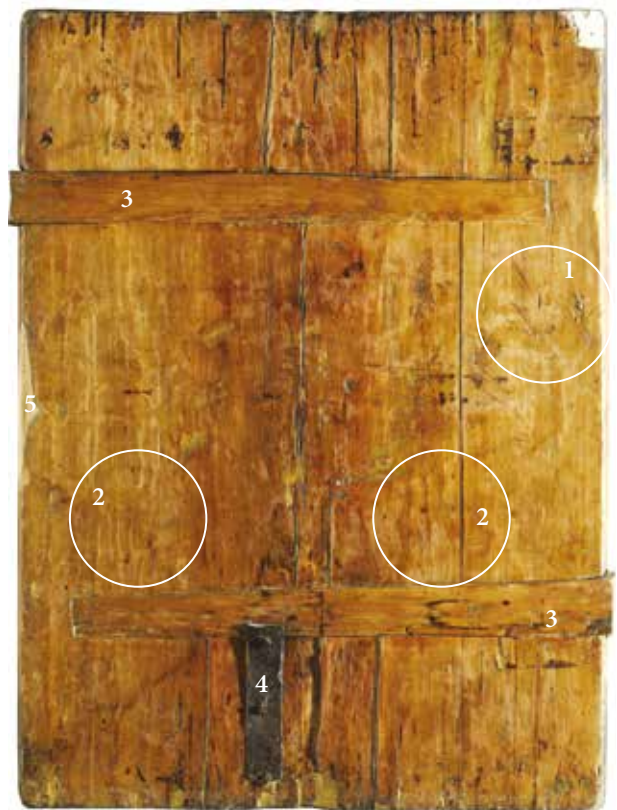
4. Ikonos skydo nugarinės pusės nuotrauka. Matyti kirvio (1) ir skobimo įrankio (2) palikti pėdsakai, priešpriešinės reljefinės įvorės (3), metalinė plokštelė (4), medinis lopas (5)
